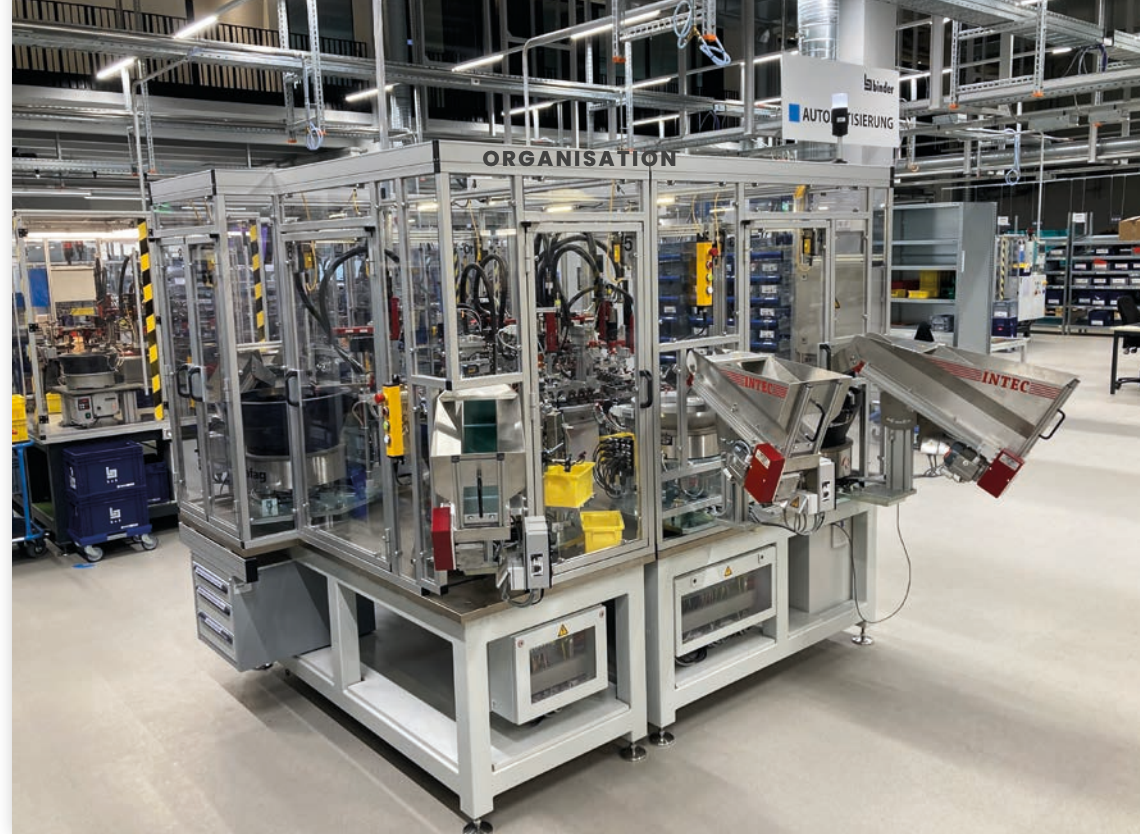
Der Schraubautomat „PG-Twin 2“ ist für die Herstellung von 23 verschiedenen Kupplungshülsen-Baugruppen konzipiert.
